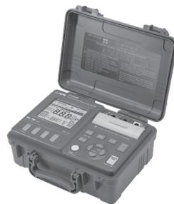
**Medidor de aislamiento hasta 5kV**
