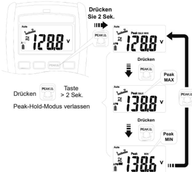
In der Peak-Hold-Funktion zeichnet das Messgerät den Peak-Min.- und den Peak-Max.-Wert auf. Wenn die Eingabe unter den aufgezeichneten Minimalwert oder über den aufgezeichneten Maximalwert geht, zeichnet das Messgerät den neuen Wert auf. Drücken Sie die Hold-taste, um die Aufzeichnung anzuhalten.
