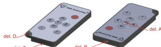
det. A – function buttons; det. B – IR transmitter; det. C - CR2025 battery; det. D – place for a strap.
